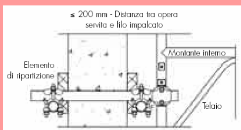
Esempio di ancoraggio "a cravatta"
